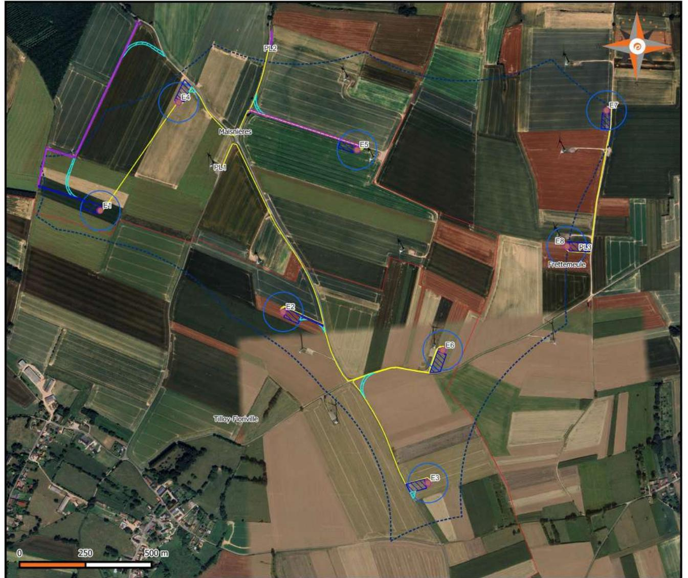
Remplacement des 12 éoliennes existantes par **8 éoliennes de 180 m** en bout de pale
